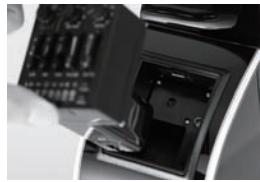
4. 更に、取り外した上部ユニットを元の方向に合わせ押し込んで取り付けます。スムーズに押し込めない場合、無理に装着せず各部を点検し問題のないことを確認してから行って下さい。上部ユニット装着後、着脱ツメにゆみがなく確実に本体と固定されている事を確認して下さい。
