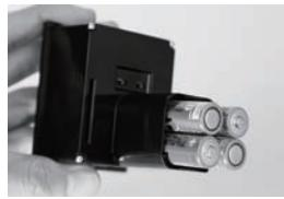
3. 電池交換後、上部ユニットを本体に戻します。内側にゴミなどの異物や異常がないか確認してから上部ユニットを戻して下さい。取り付けがスムーズでない場合、無理に押し込まず各部を点検し問題のないことを確認してから行って下さい。
